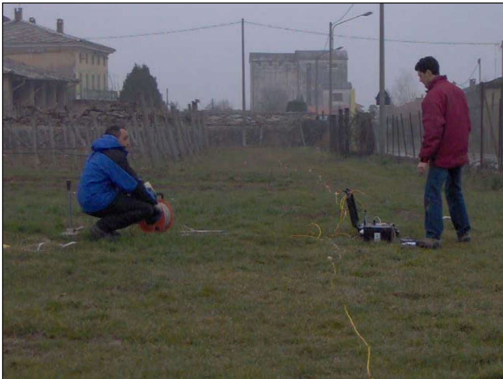
Figura 6 Stendimento G2 sismica a rifrazione
